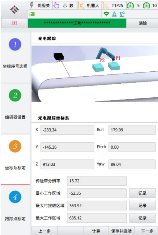
图 18-光电跟踪坐标系标定步骤 3
