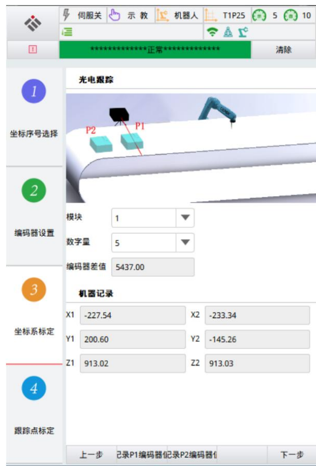
图 16-光电跟踪坐标系标定步骤 1
