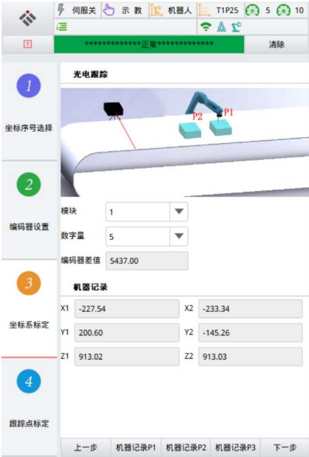
图 17-光电跟踪坐标系标定步骤 2
