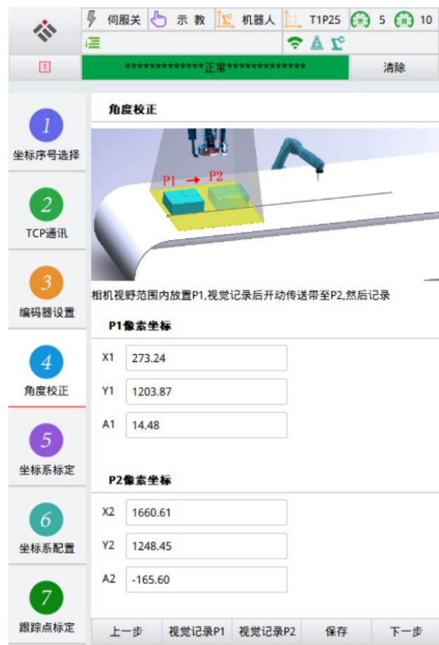
图 3-相机安装角度校正
